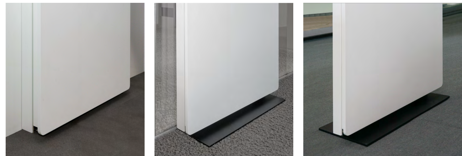
Das W6 Grundmodul sorgt für die Lastabtragung des Displays. Eine einfache Wandfixierung ist ausreichend – auch an Leichtbauwänden ohne aufwändige Wandverstärkung! Mittels L-Fuß kann, z. B. vor einer Glaswand, auf die Wandfixierung verzichtet werden. Ein T-Fuß ermöglicht die freistehende Positionierung im Raum.
